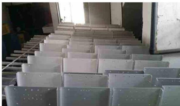
L'anodizzazione è un processo di ossidazione al quale viene sottoposto l'alluminio mediante bagno elettrolitico che conferisce alla superficie un sottile strato di ossido, sia per scopo funzionale (aumentarne la durezza e la resistenza alla corrosione) che per scopo estetico. La Seritarghe effettua sia l'**anodizzazione naturale**, che la **colorata**, disponibili nei seguenti colori: Nero, Rosso, Verde, Blue, Azzurro, Giallo.
