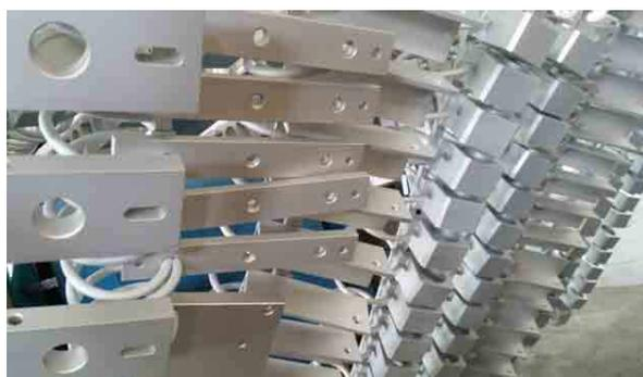
La passivazione tipo Surtec 650, un'eccellente protezione dalla corrosione paragonabile alle passivazioni esavalenti (Alodyne 1200), si contraddistingue per le seguenti caratteristiche:
